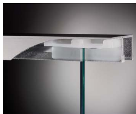
Anslagsdæmper klikkes op i føringsprofilen og dæmper døren.
